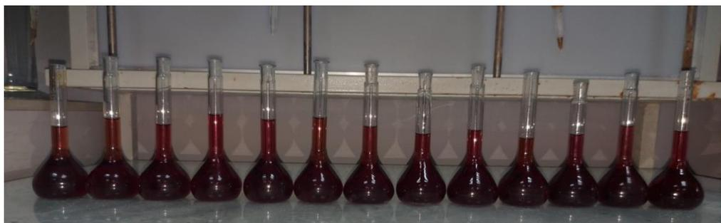
Рисунок 7 - Определение бора в растворах магнийсодержащих борофосфатов
