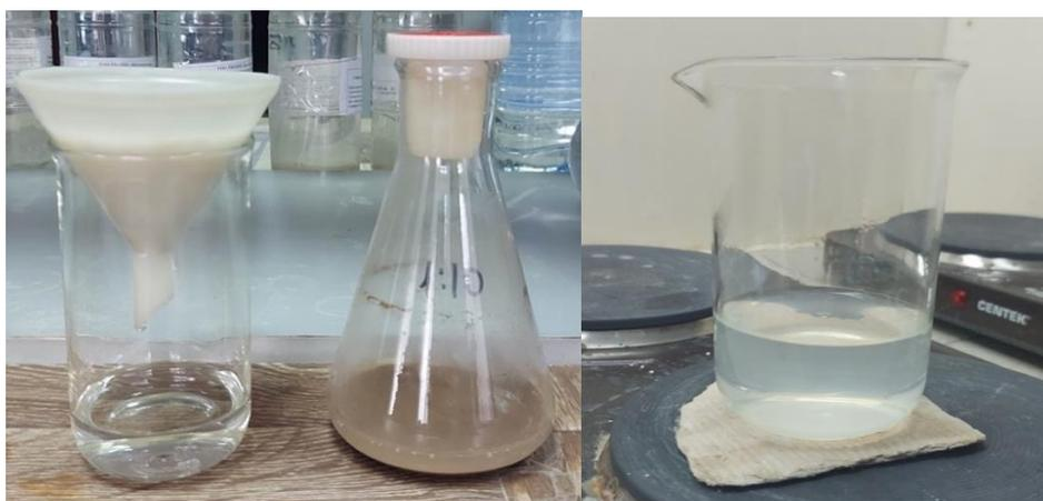
Рисунок 6 - Фильтрация пульпы и упаривание фильтрата
