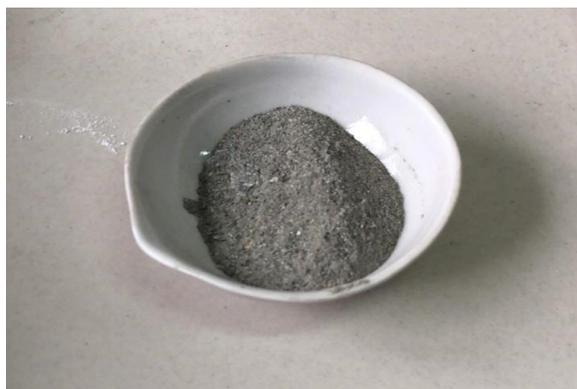
Рисунок 2 - Внешний вид технологических отходов производства хризотил-асбеста месторождения Жетыгора
